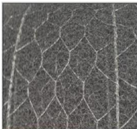
Obrázok 5 – Sieť z drôtu dvakrát stočeného v okách vystužená drôtenými lanami s prídavnou georožou
